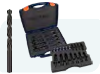
202-dlg. HSS-R spiraalborenset in kunststof koffer Type 100 10x ø1 - 8 / 0,5mm oplopend; 5x ø8,5 - 10 / 0,5mm oplopend; 2x ø10,5 - 13 / 0,5mm oplopend; 10x Tapmaten ø3,3 en 4,2mm
