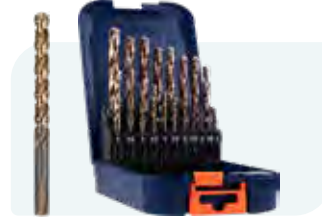
19-dlg. HSS-G spiraalborenset in ABS-cassette Type 107, geslepen 1x ø1 - 10 / 0,5mm oplopend
