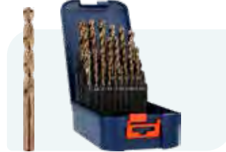
25-dlg. HSS-E spiraalborenset in ABS-cassette Type 116, geslepen 1x ø1 - 13 / 0,5mm oplopend
