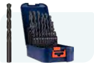
25-dlg. HSS-R spiraalborenset in ABS-cassette Type 100, rolgewalst 1x ø1 - 13 / 0,5mm oplopend
