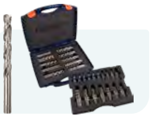
202-dlg. HSS-G spiraalborenset in kunststof koffer Type 105 10x ø1 - 8 / 0,5mm oplopend; 5x ø8,5 - 10 / 0,5mm oplopend; 2x ø10,5 - 13 / 0,5mm oplopend; 10x Tapmaten ø3,3 en 4,2mm
